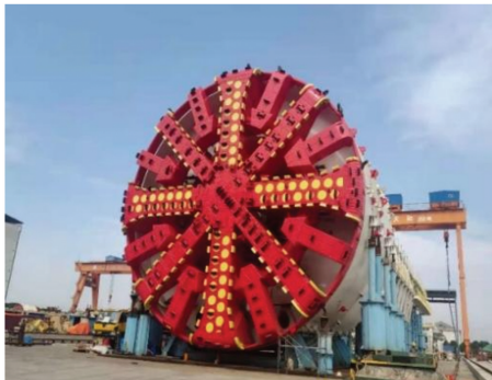
图3 盾构机刀盘示意图
