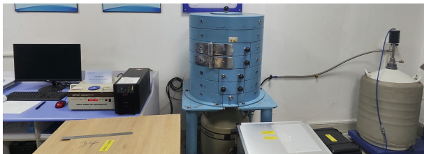
图3 GMX40P 高纯锗伽马谱仪平台 Fig. 3 GMX40P high purity germanium gamma spectrometer platform
