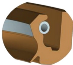
图 1 低摩擦涂层唇形密封喷涂区域
