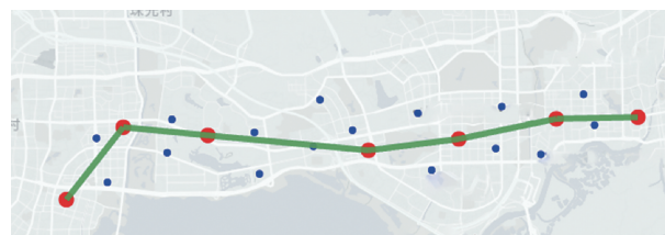
绿色线路是以 S_{72}^b 和 S_{78}^b 为起终点的第七条链条的子链条, 即线路 C_{7,2} = \{S_{71}^b, S_{72}^b, \dots, S_{78}^b\} ; 红色为基准站点; 蓝色为需求响应站点
