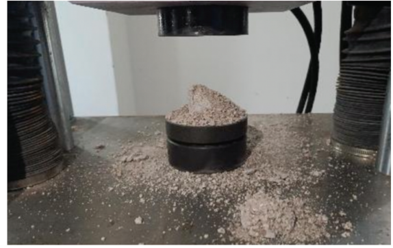
图7 600 °C 循环 6 次的水冷岩样在单轴压缩荷载下出现瞬时粉碎
