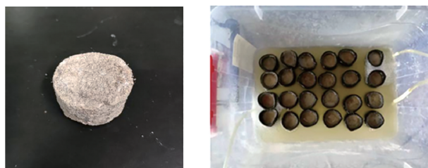
(a) 高低温核磁试件(20 mm×40 mm) (b) 浸泡在营养液中的试件
