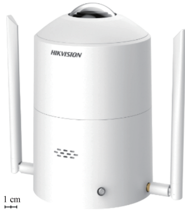
图1 海康 DS-2CD83C6F 全天空成像仪 Fig.1 Haikang DS-2CD83C6F all sky imager
