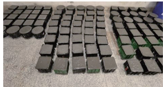
图5 试件浇筑(150 mm×150 mm×150 mm) Fig. 5 Specimen pouring(150 mm×150 mm×150 mm)
