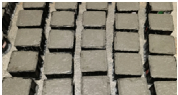
图3 混凝土浇筑和静置
