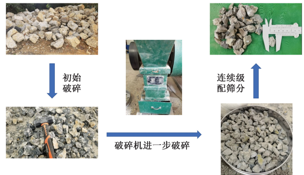
图2 再生粗骨料破碎筛分过程
