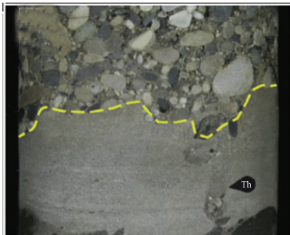
(a) 颗粒-中等卵石砾岩与碳质碎屑砂岩接触线(黄色虚线)
