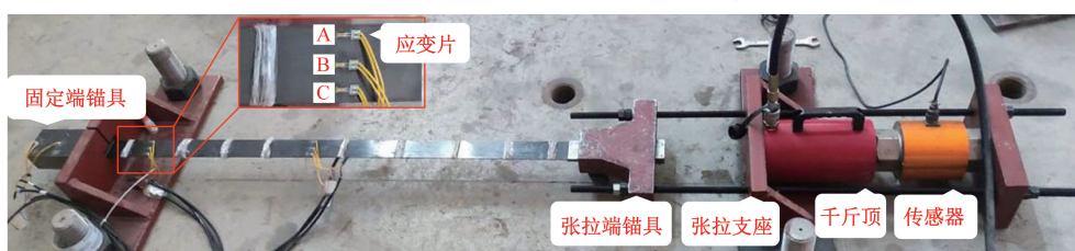
图 8 试验试件组装完成
