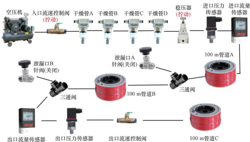
图6 试验台搭建示意图
