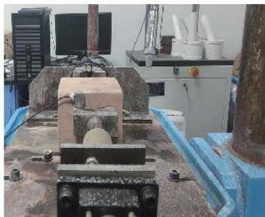
(b) 岩样夹持及传感器安装
