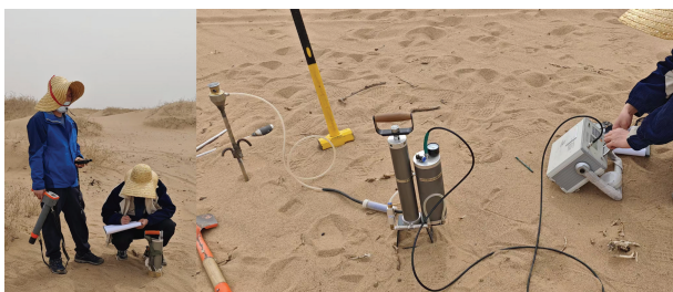
图6 伽马能谱测量(左)、土壤氡测量(右)野外工作图
