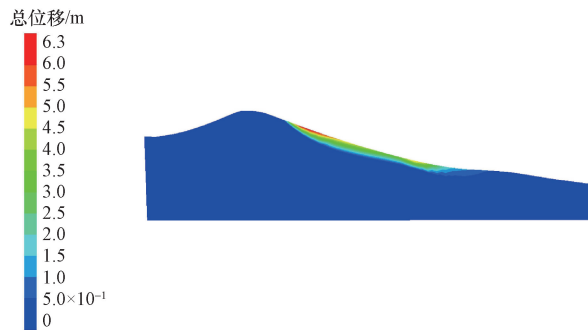
图 16 地震作用下位移剖面(主滑方向)
