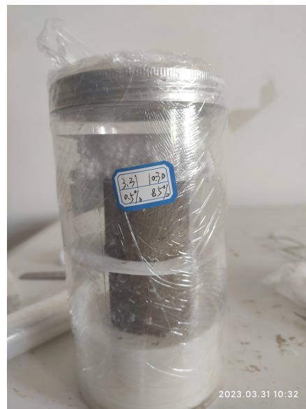
图 5 滤纸法试验试件
