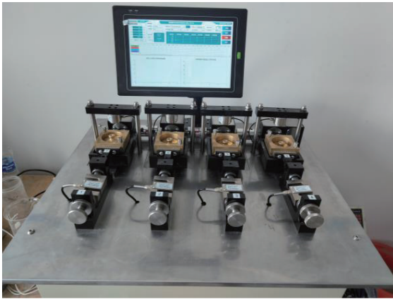
图 3 Z-J 型智能直剪仪
