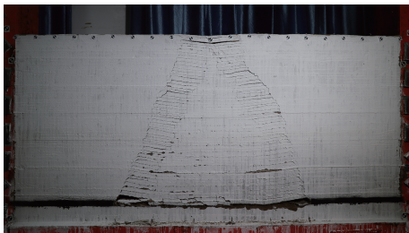
图 4 模型完全开采后的岩移形态(推进 400 m)
