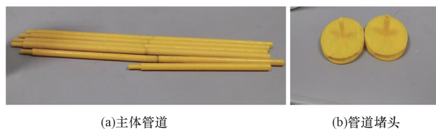
图1 管道3D建模成品
