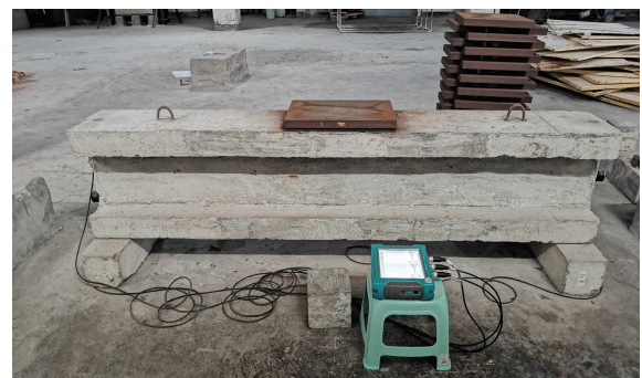
图6 三点弯曲试验现场加载示意图
