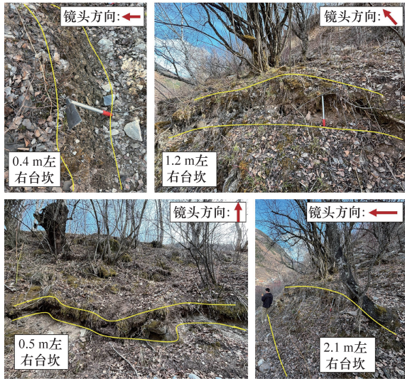
图 10 滑动区部分台坎细节图
