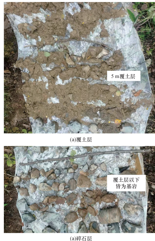
图9 钻孔揭露坡体覆土厚度图
