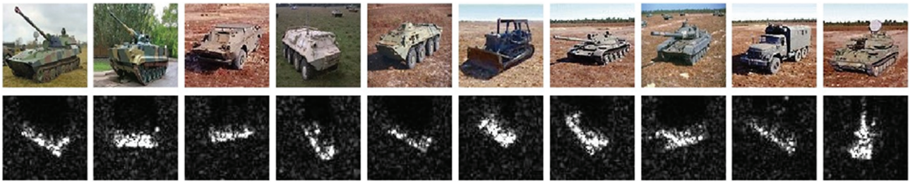
图7 MSTAR 10类目标的光学形态及其对应的 SAR 成像形态
