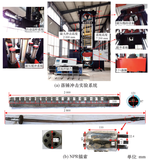
图6 落锤冲击试验系统和 NPR 锚索
