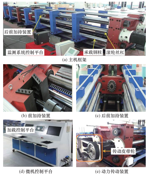
图1 NPR锚索静力拉伸试验系统 Fig. 1 NPR cable tensile testing machine
