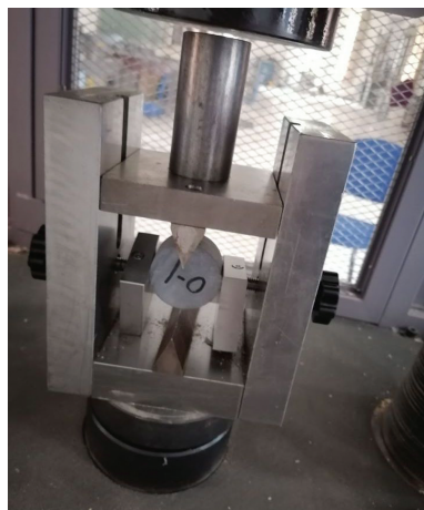
图5 岩样和巴西劈裂夹具的安置
