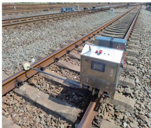
图 13 涂油装置实验示意图
