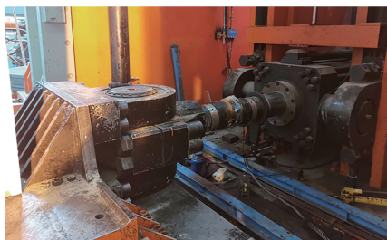
图4 压力试验机作动器 Fig.4 Pressure testing machine actuator
