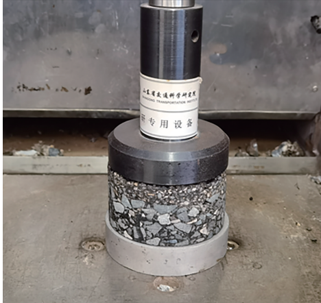
图7 拉拔试验图 Fig.7 Pull-out test
