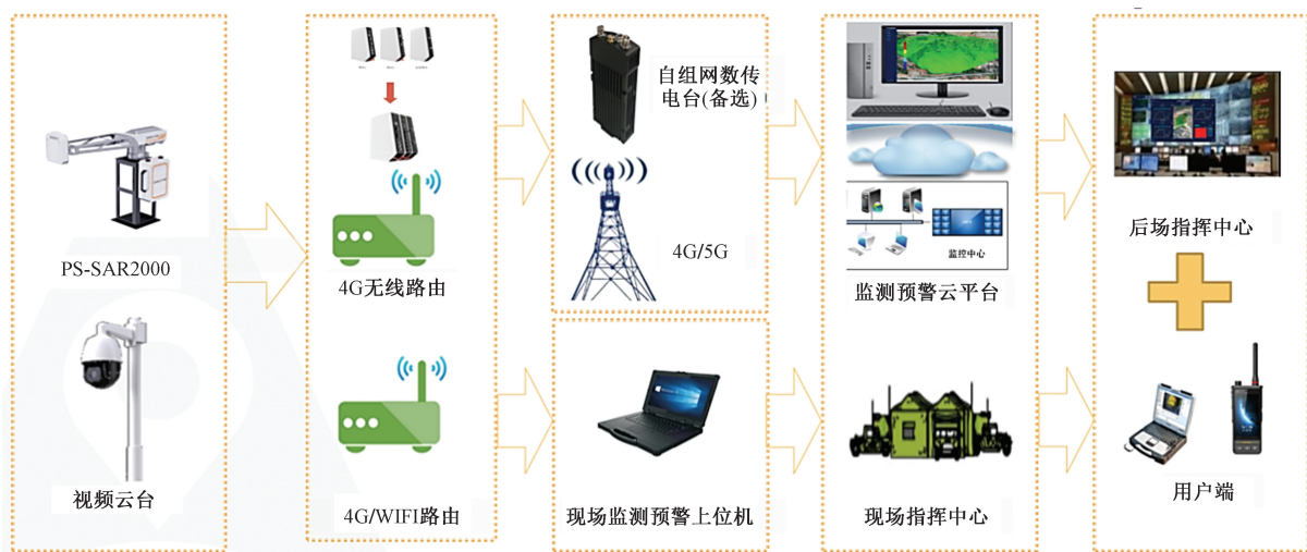
图6 万源露天煤矿边坡雷达变形监测预警平台
