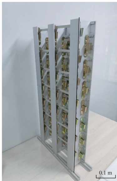
图 19 装配式临时支撑结构
