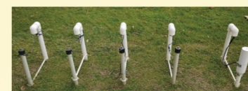
深层地温：能探测到地下 3 米多深的温度！
