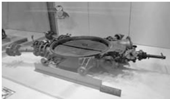
图 1 理研再建加速器的离子加速箱（该图为实物，作者摄于日本国立科学博物馆）
