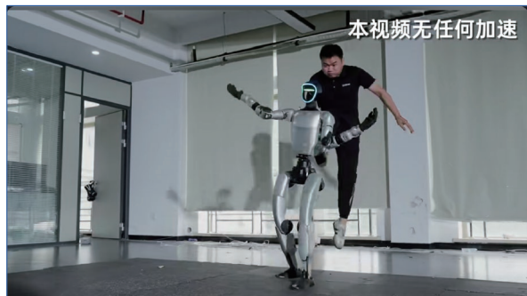
图2 宇树科技 G1 室内抗冲击平衡测试
