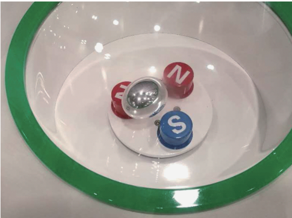
图3 使用磁铁代替三相交流线圈的“旋转的金蛋”
