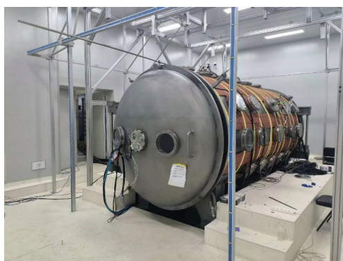
图3 冷等离子体测试定标系统
