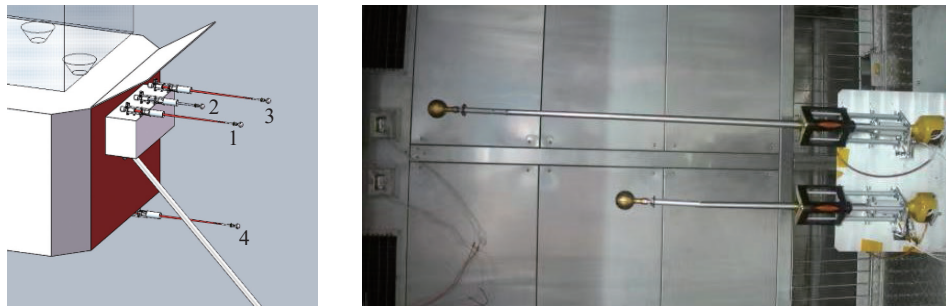
图 2 电场探头在嫦娥七号着陆器上的部署 (a) 和实物照片 (b)
