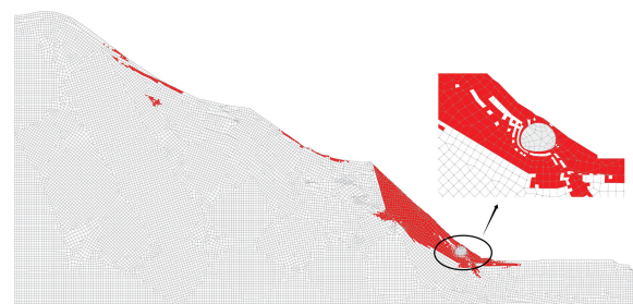
图 9 坡体 C 型滑移边坡塑性区
