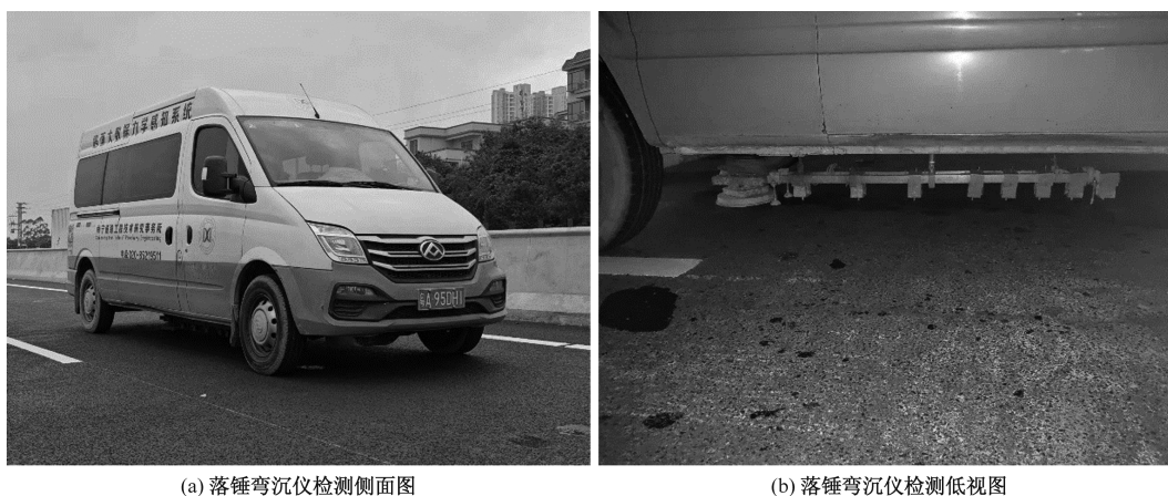
图 5 落锤式弯沉仪现场检测
