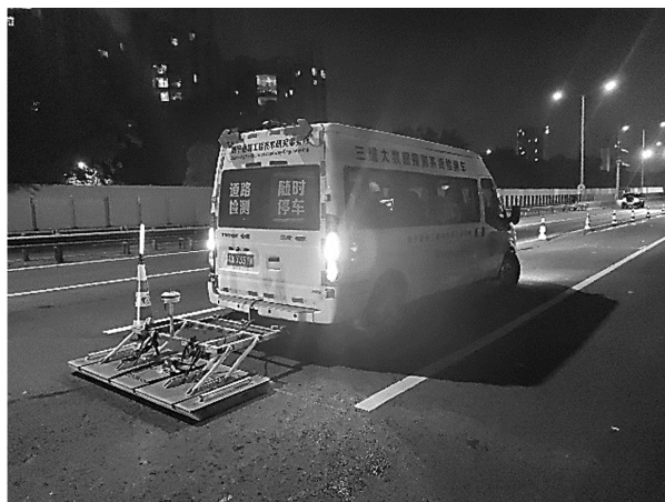
(a) 三维雷达现场勘测图
