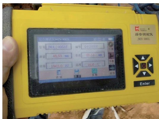
图3 现场测试柔性位移计的变形
