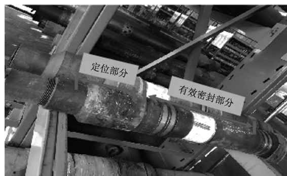
图 2 定位密封结构实物
