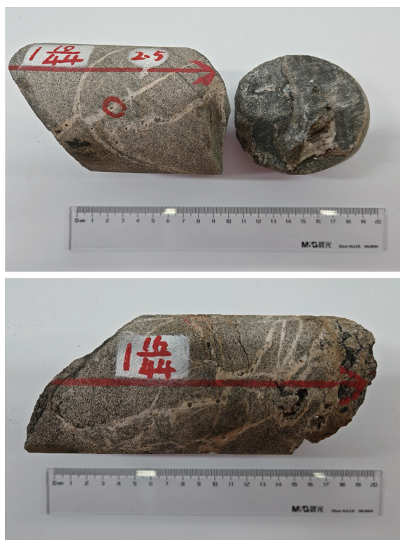
图4 丰谷119井岩心裂缝和孔洞
