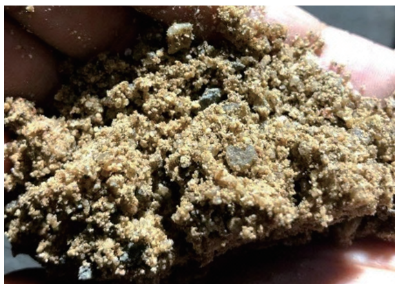
图1 疏松砂岩浸水后性状
