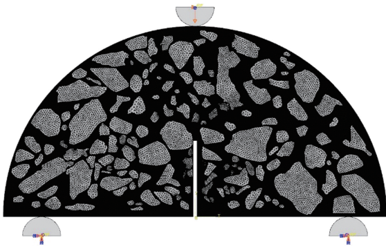
图 5 SCB 试验有限元模型
