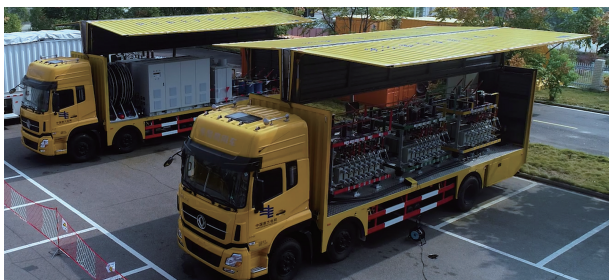
图9 空负载试验平台1号车和2号车实物
