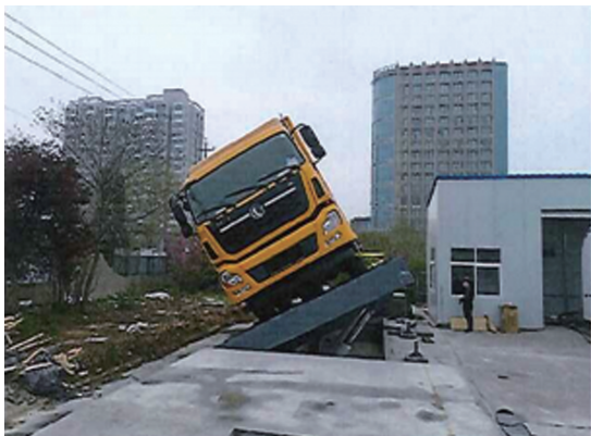
图10 空负载试验平台1号车和2号车侧翻试验现场
