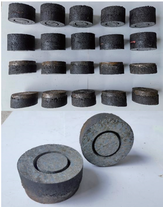
图 8 双层结构试件钻芯
