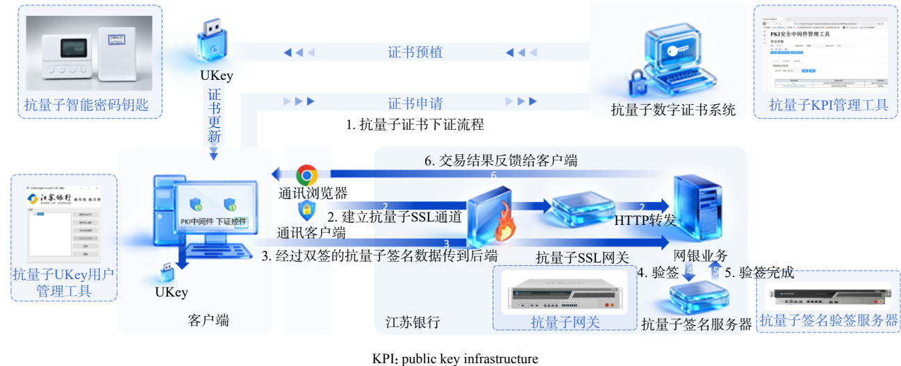
图 1 全栈量子网银系统的总体架构与数据流向
