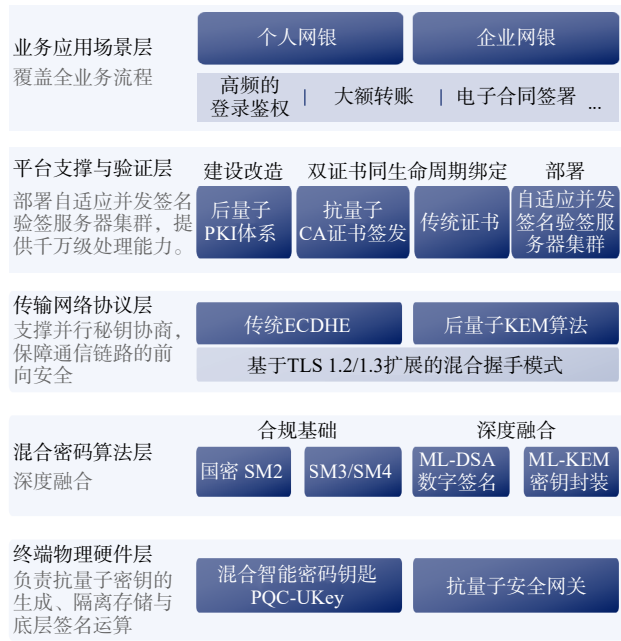
图 2 全栈量子网银系统总体架构
