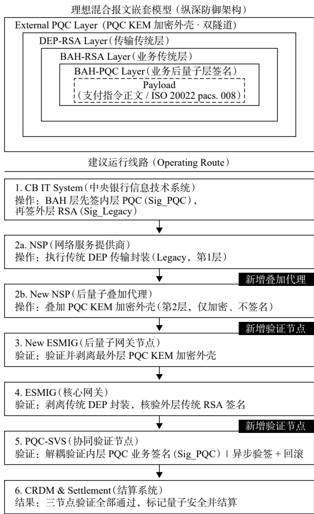
图2 建议的模块化解耦验证路径与报文结构全景
