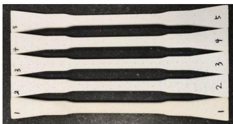
图 2 水氧腐蚀试验的拉伸试样型式
