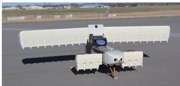
图 14 XV-24A 缩比验证机 Fig. 14 XV-24A scaled demonstrator UAV
