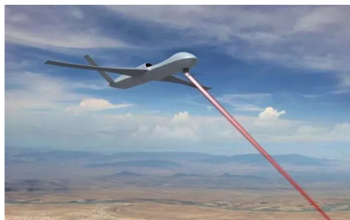
图3 通用原子能公司的捕食者C型无人机 搭载机载激光样机方案
