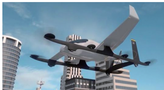
图 19 电动垂直起降飞机 1:4 缩比验证机 Fig. 19 Electric power driven vertical 1:4 scaled demonstrator
