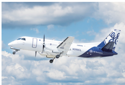
GE Aerospace改装的萨博340B混合动力电动试验机。该机搭载兆瓦级混合动力电推进系统,完成3万英尺以上高空飞行测试,并跨越大西洋飞抵英国
