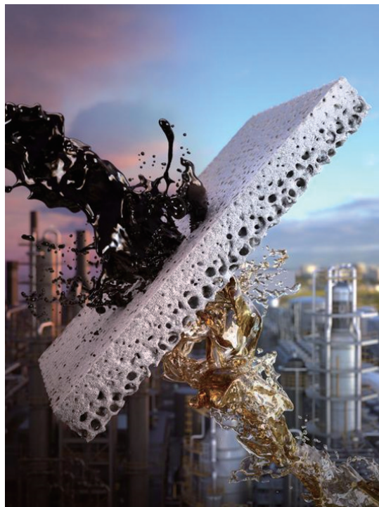
一种廉价的多孔聚合物膜在稳定状态下 分离真实原油;重质组分沉积后 形成更窄的分离通道 (图片来源:韩国科学技术院)
