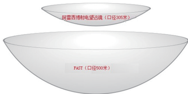
图3 FAST与美国阿雷西博射电望远镜对比示意
