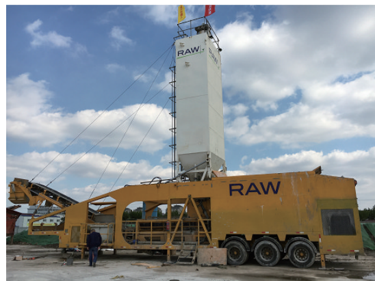
图1 异位S/S混合修复设备
