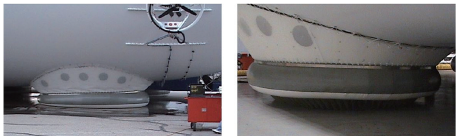
图7 吸附、垫升状态下的气垫着陆器
