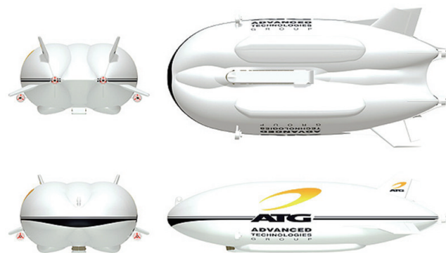
图30 Sky Cat飞艇双体船式气垫着陆器 Fig. 30 Catamaran ACLS of Sky Cat airship
