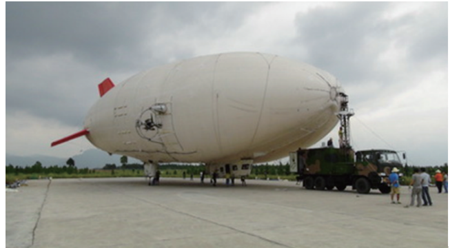
图 28 中国航天科工 068 基地双椭球体飞艇 Fig. 28 Double ellipsoid airship of 068 base
